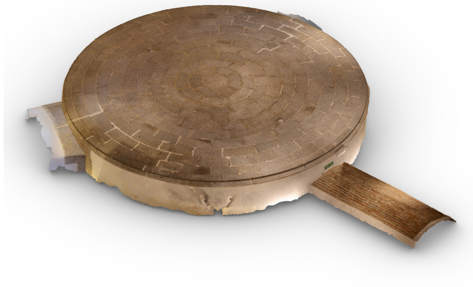
Figura 3.8. Modelo tridimensional de la bóveda semi-plana de la planta baja del castillo-palacio de Magalia.
