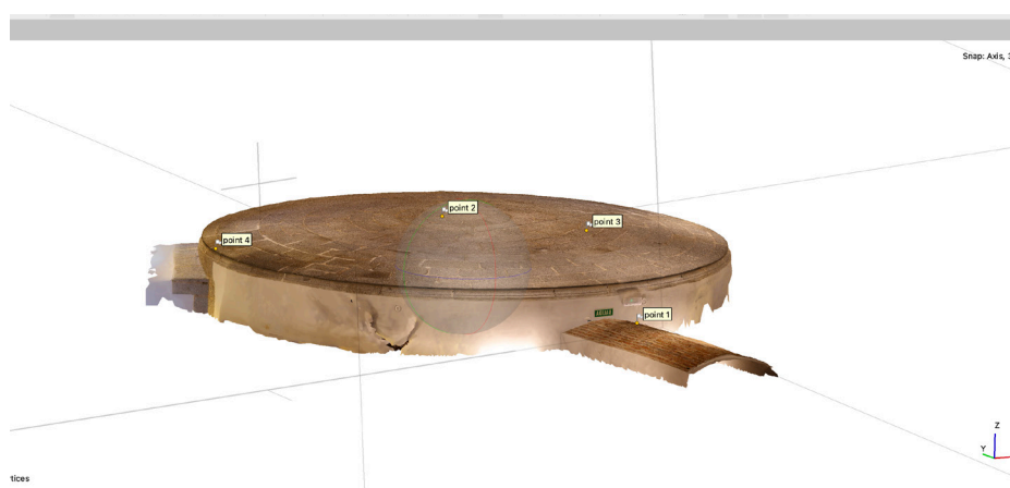
Figura 3.15 Modelo texturizado orientado y escalado mediante puntos de referencia
